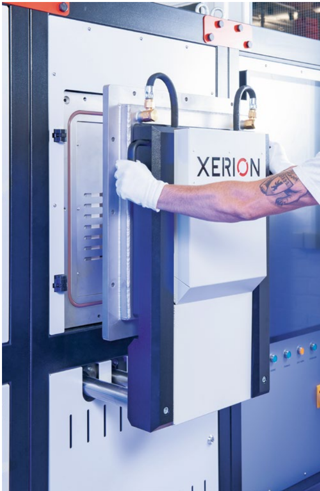
Bild 5 Der Sinterofen ist als Multi-Atmosphärenofen ausgeführt. (© Xerion Berlin Laboratories)
