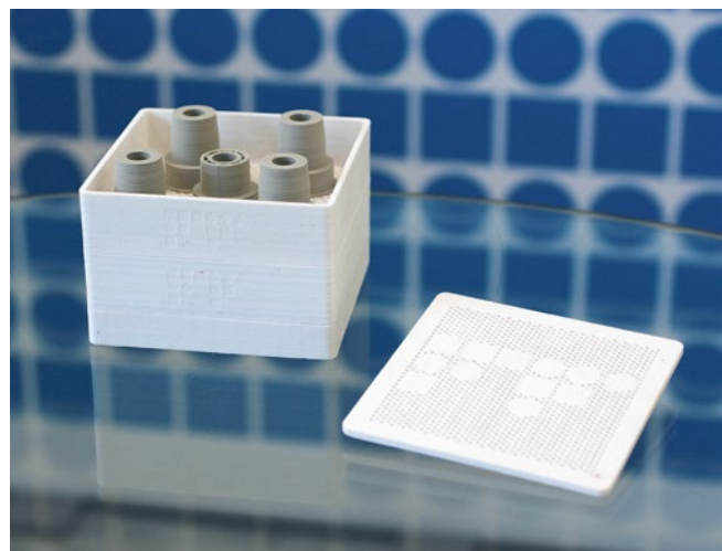
Bild 9 Sinterboxen mit den Maßen 100 mm x 100 mm x 40 mm (Breite x Tiefe x Höhe) mit Deckel (© Xerion Berlin Laboratories)
