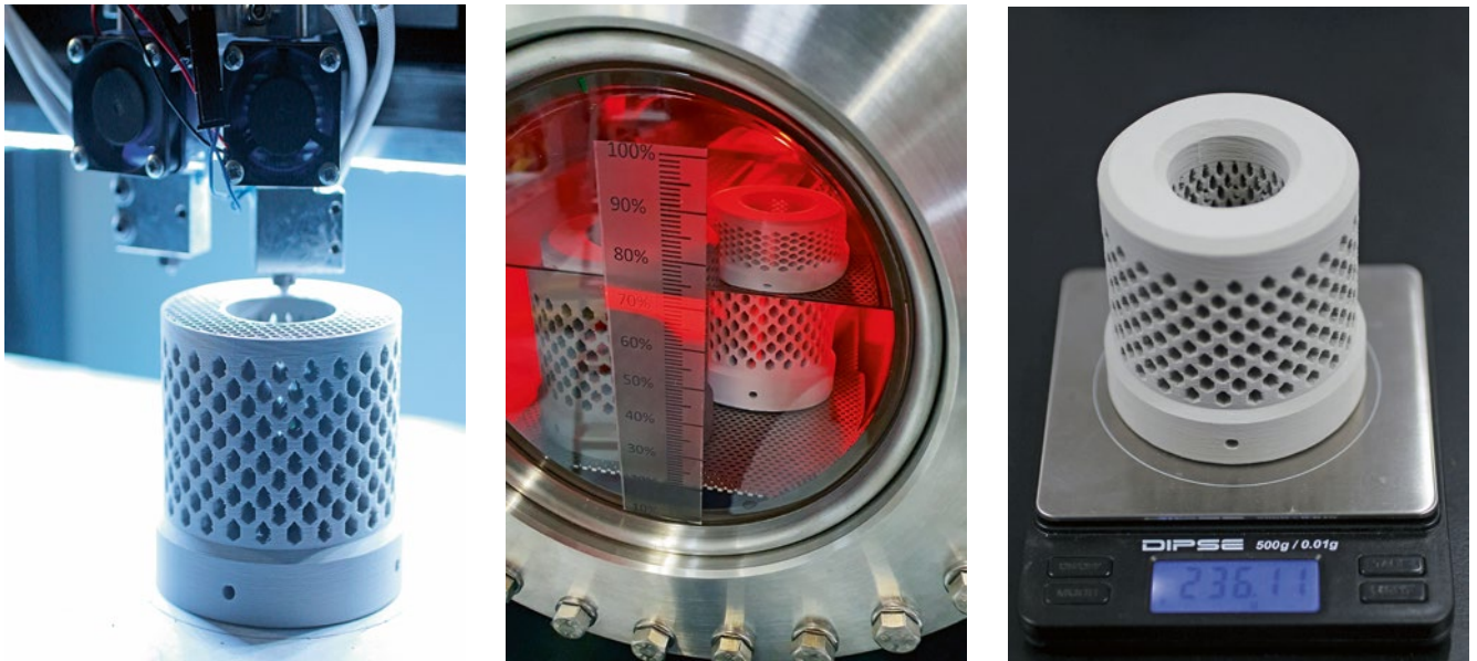
Bild 10 Heißgaskerze während des Druckes (links), während der Entbinderung (Mitte) und fertiges Bauteil (rechts) (© Xerion Berlin Laboratories)
