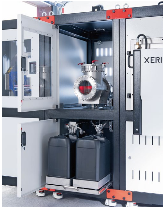
Bild 4 Die Entbindereinheit ist so ausgelegt, dass beim Aufbau keine Explosionsschutzzone nötig ist. (© Xerion Berlin Laboratories)
