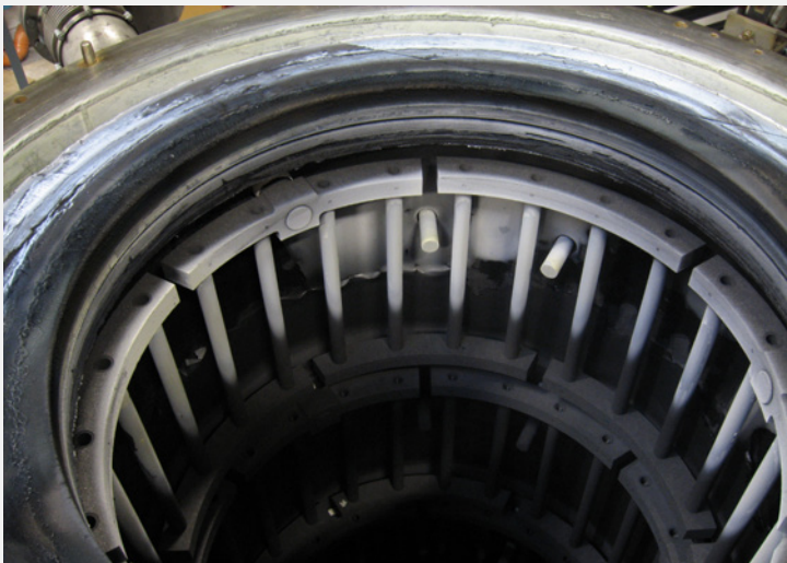
Bild 1: Innenaufbau CVD-Produktionsanlage (Nutzraumdurchmesser 1.000 mm)
